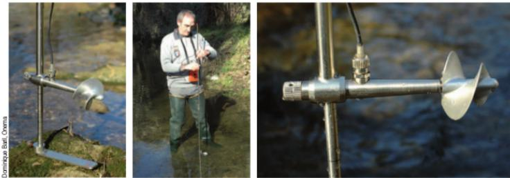
FIGURE 2.9 – Exemple de montage d'un courantomètre mécanique (moulinet)
