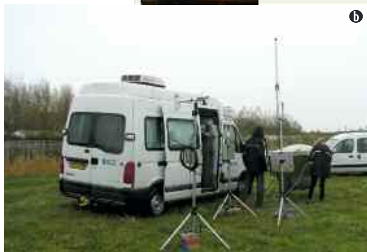
▲ (b) : la station mobile de radiosondage. 160 radiosondages mobiles (sur un total de 192) ont été réalisés pendant la SOP1 d'HyMeX sur les sites de Vias, Marseille, Fréjus et Candillargues.
