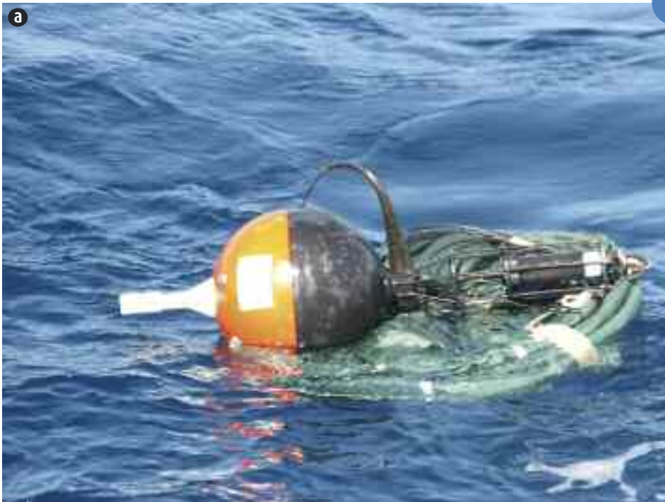
(a) : mise à l'eau d'une bouée dérivante mesurant la salinité pour HyMeX. (b) : déploiement d'une bouée dérivante Marisonde pour HyMeX.
