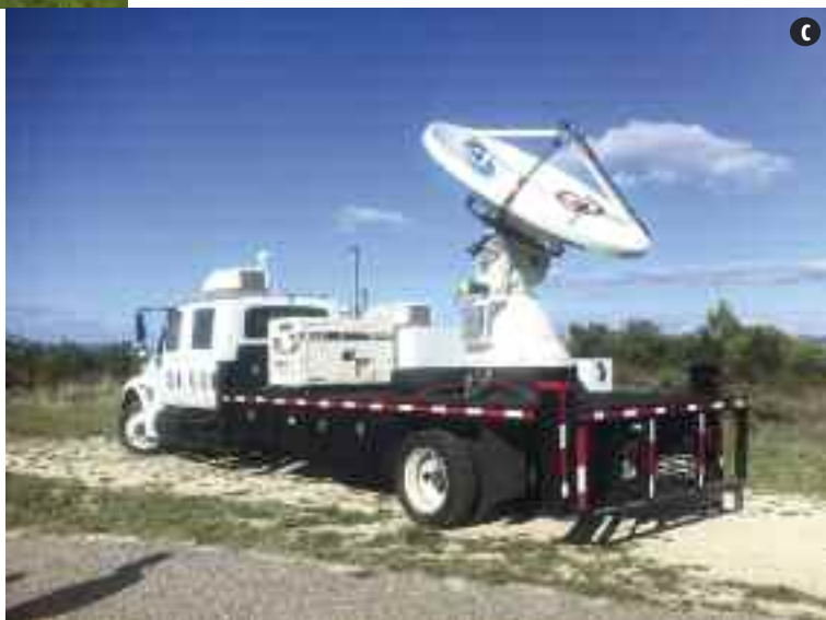
▶ (c) : le radar polarimétrique mobile NO-XP du National Severe Storm Laboratory (USA). Ce radar, déployé au sommet du Mont Bouquet, est l'un des cinq radars de recherche mis en œuvre pendant la SOP1 d'HyMeX.
