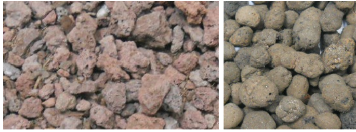
FIGURE 5.5 – Exemple de sols utilisés pour une toiture végétalisée standard située au CETE de Nancy, avec à gauche, le substrat, et à droite, les billes d’argile expansée qui constituent une couche de drainage. Source : R. Bouzouidja
